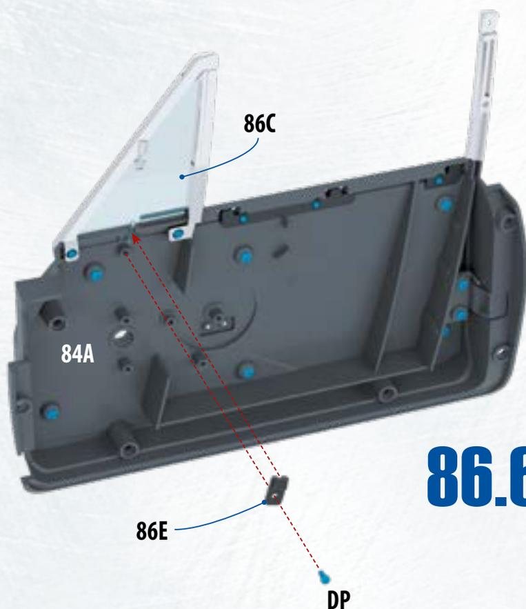
**86.6** **УДЕРЖИВАЯ** стекло 86С на месте, установите кронштейн 86Е поверх его нижнего штифта. Закрепите кронштейн на детали 84А с помощью винта DP. ◀
